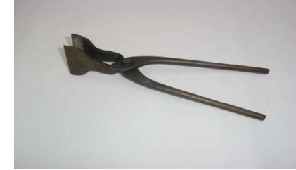
平拵箸（1丁） 寸法90mm以下 飲み込み60mm以内
