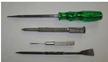
けがき針（2本まで） ポンチ類（2本まで） 共に形状・大きさに指定なし
