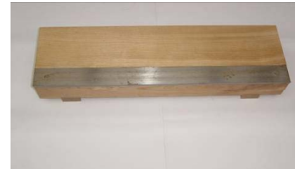
折台（木台に固定） 寸法指定なし 折台と木台は同じ長さであること 折台をはずしての使用は不可
