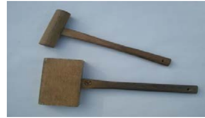
田楽木槌（2丁まで） 木槌（2丁まで） 共に寸法指定なし テーパ形状のものは使用不可
